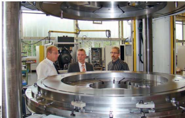
Die speziell entwickelten, kreisrunden Heizplatten mit radial angeordneten Heizzonen ermöglichen ein hohes Energieeinsparungspotenzial
